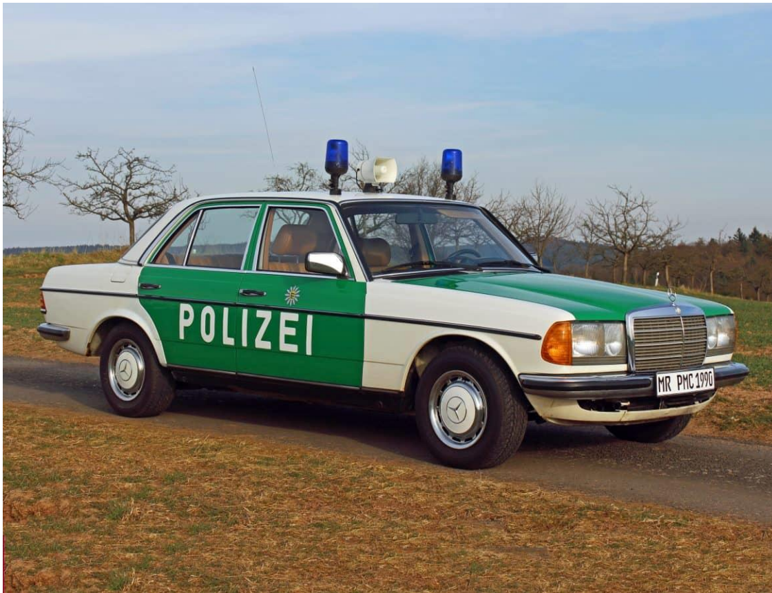
Mercedes-Benz 280 E - Baujahr 1984, 2,8 L, 6 Zylinder Ottomotor, Automatik, 185 PS
