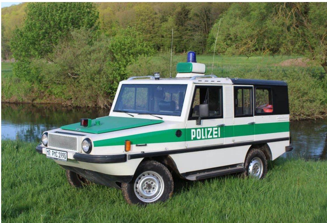
Amphi Ranger - Baujahr 1983, 2,8 L, V-6 Zylinder Ottomotor, 145 PS, Allradantrieb
