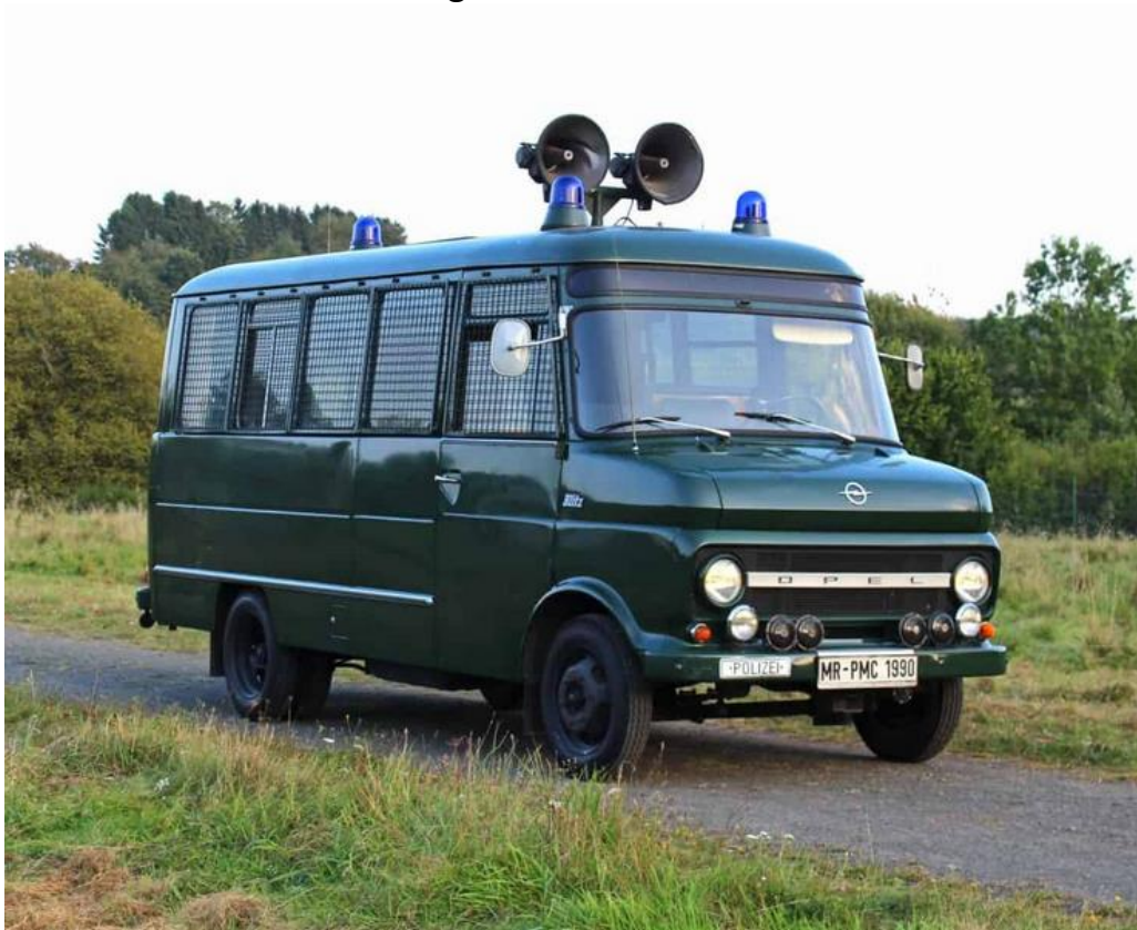
Opel Blitz - Baujahr 1972, 2,6 L, 6 Zylinder Ottomotor, 80 PS
