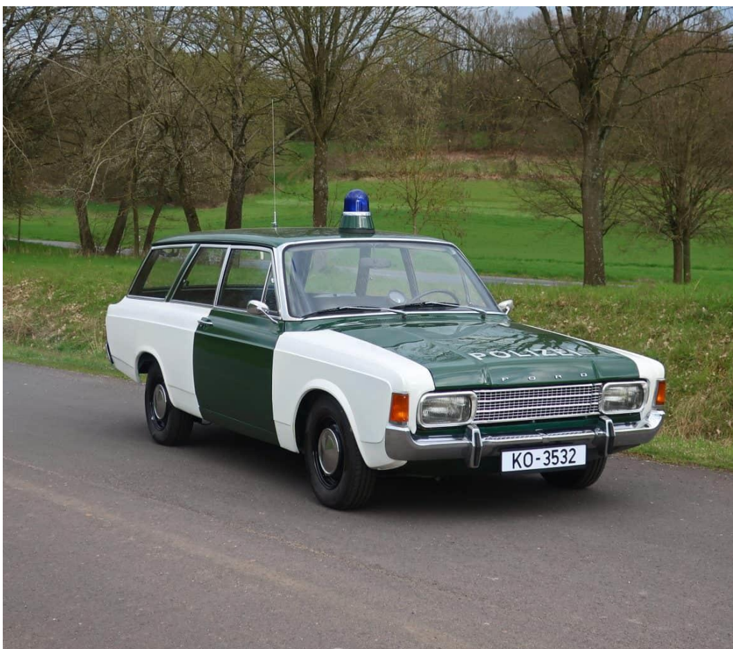
Ford 17M Turnier - Baujahr 1971, 1,7 L, 4 Zylinder Ottomotor, 65 PS
